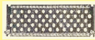
1895 Radiateur de tramway, constitué de fils en maillechort tendus entre des isolants en porcelaine (extrait de « Electric heating », par Edwin J. Houston et A. E. Kennedy, 1895)
